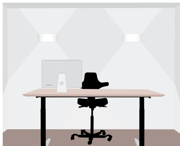
Det er vigtigt, at lysarmaturer til almen belysning ikke placeres lige over eller foran et arbejdssted. I kontorer med tilstrækkelig rumhøjde anbefales anvendelse af op- og nedadlysende armaturer.
